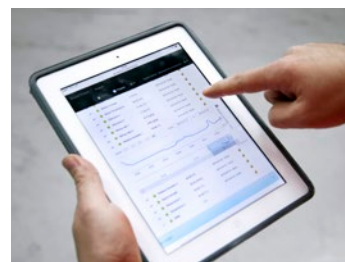
Avec SuperVision®, le processus d'assèchement est piloté, surveillé et mesuré à distance via un ordinateur, un téléphone portable ou une tablette.
