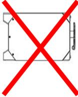
**L'appareil doit être transporté en position verticale et doit toujours être dans cette position durant son fonctionnement.**
